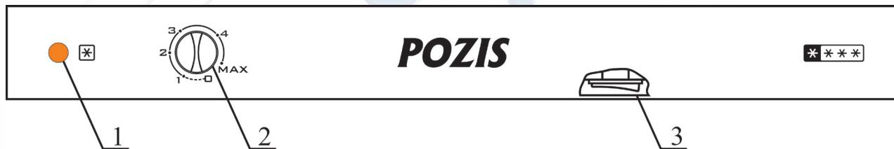
Рис.2 Схема расположения приборов управления и сигнализации
